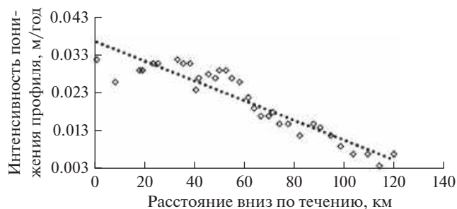
Рис. 4. Изменение интенсивности трансгрессивных деформаций по длине р. Белой ниже Уфы за 1965–1999 гг.
